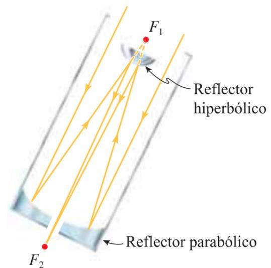
**FIGURA 8** Telescopio tipo Cassegrain
